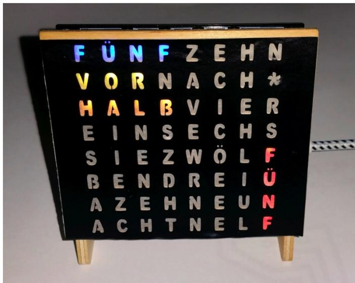
**RGB-Worldclock**, bei der die Uhrzeit in Wörtern (z.B. "fünf vor zehn") angezeigt wird.
