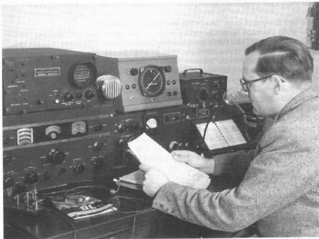
Wolfgang Assmann, DL3DC, an seiner Station. Von hier verlas er ab 1951 für 4 Jahre regelmäßig jeden Sonntag den Hessen-Rundspruch. Auf dem Bild erkennt man links den Empfänger, einen AR 88, darüber den Panorama-Zusatz. Rechts neben dem Lautsprecher das Steuergerät für den Beam und ein Frequenzmesser BC 221, darunter der Modulationsverstärker.
